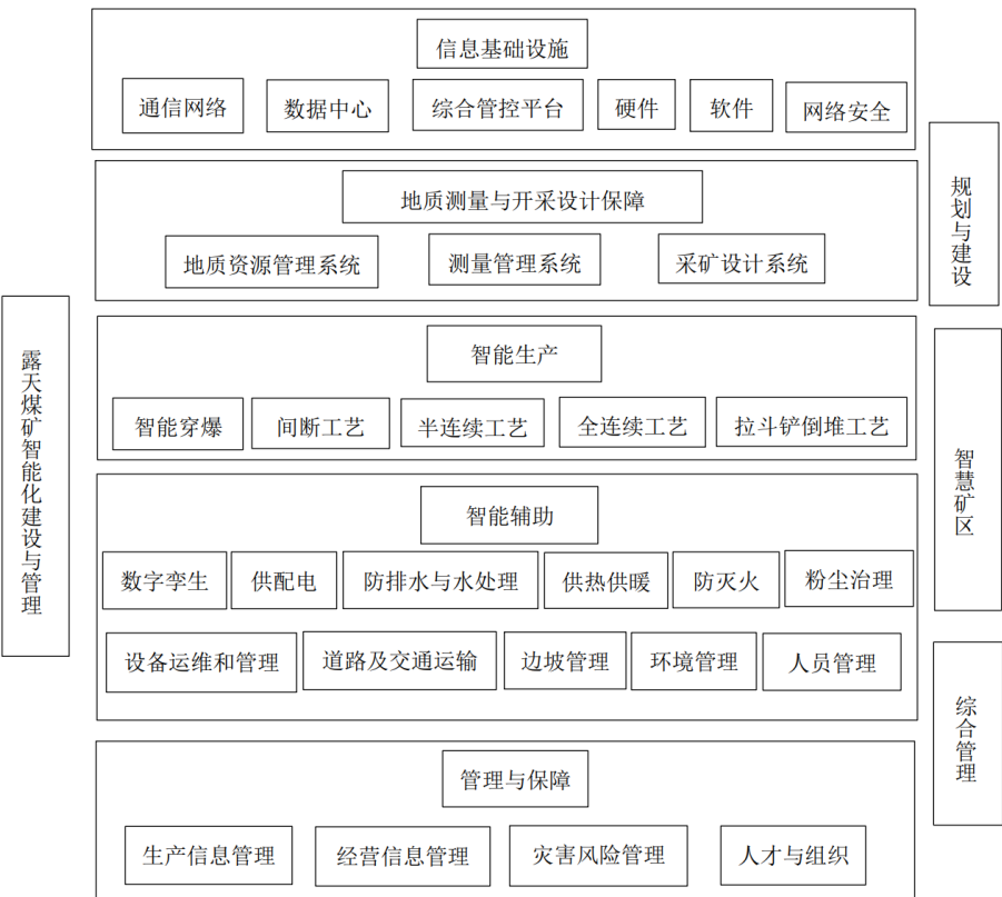
图1 露天煤矿智能化建设与管理规范基本架构
